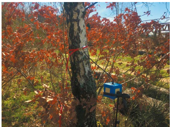
Captation du son de la montée de sève d'un bouleau à l'aide d'un stéthophone fait maison
